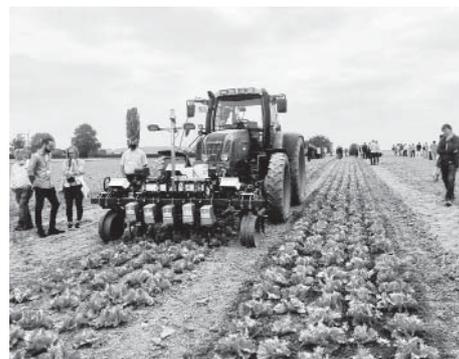
*Ein Kamera und Sensor gesteuerter Jätroboter während einer Feldvorführungen beim DiWenkLa-Tag.*
